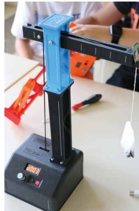
Der Tee-Kran senkt den Teebeutel in eine Tasse und hebt ihn nach der eingestellten Zeit wieder heraus.
