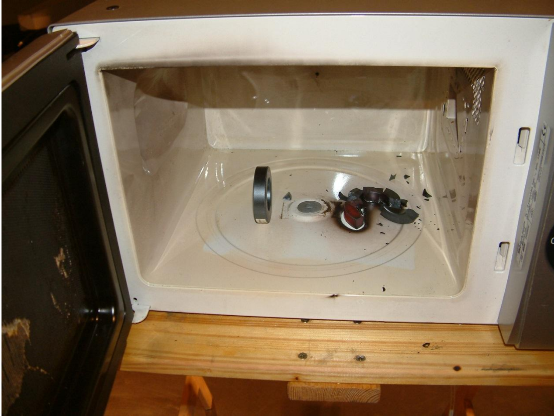
WE-TOF Ferritring nach Bestrahlung mit 800W
