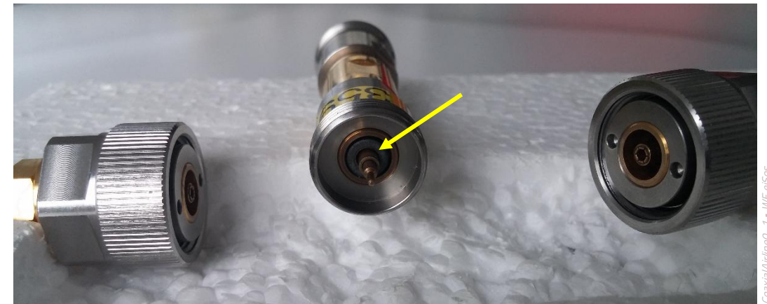
Luftleitung mit Ferritring auf Innenleiter
