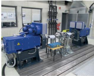
im Raum, verbunden mit der Idee, einen modernen Prüfstand für PKW-Elektroantriebe an der Hochschule zu errichten. Ein Team aus Kollegen der Fakultät T1 und speziell auch ASE erarbeitete zusam-
