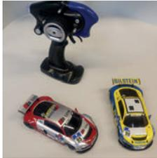
MAD ist eine Mini-Plant-Anlage im Maßstab 1:24 zur Entwicklung von Funktionen für das automatisierte Fahren. Mit MAD können durch Einsatz von Modellen der Mini-Z-Rennserie, von Videosensorik und Echtzeit-Computer verschiedene Verkehrsszenarien aufgebaut werden, u.a. Automated Valet Parking, Kreuzungen, Kreisverkehre. Begleitend entsteht eine
