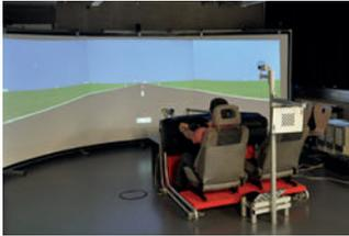
in der virtuellen Welt durchzuführen. Ein stationärer Fahrsimulator ist mit Eyetracking (smarteye) und einem berührungslosen EKG ausgestattet und ermöglicht die Untersuchung von Stresssituationen während der Fahrt. Ein zweiter, dynamischer Simulator kann die Bewegung des Fahrzeugs nachvollziehen und erhöht damit die Realitätsnähe bei den Fahrten. Zum Einsatz kommen professionelle Simulationssoftware (CarMaker) und Eigenentwick-
