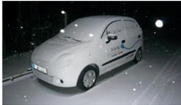
suchsfahrzeug des Studiengangs kontinuierlich Messfahrten im ländlich-urbanen Raum durchgeführt. Unterschiedliche Strecken-, Höhen und Geschwindigkeitsprofile führen auf Faktoren zur Optimierung der Reichweite von Elektrofahrzeugen. Parallel dazu wird ein identischer Elektroantrieb im Labor Antriebsprüfstand betrieben und erlaubt eine realitätsnahe Gestaltung von Prüfstandszyklen. Studentische Events mit Elektrofahrzeugen werden in Zusammenarbeit mit regio-
