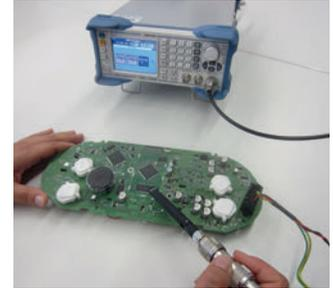
dafür Störungen mit Nahfeldsonden direkt in die Leiterplatte eingekoppelt. Auch ungewollte Abstrahlungen müssen gemessen und minimiert werden. Denn sie können z.B. den Radioempfang beeinträchtigen. Mit dem Handheld-Spektrumanalysator können diese Störungen direkt im Fahrzeug gemessen werden.
